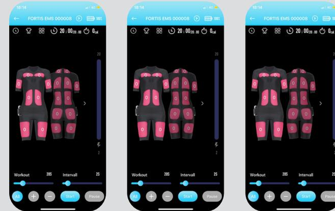
19. Steuerungsbox Auswahl: Es gibt max. 6 Box-Anschlüsse, die gleichzeitig für das Gruppentraining verwendet werden können. Wählen Sie die Steuerfelder separat aus oder klicken Sie auf „Alle“ um alle zu verbinden.
